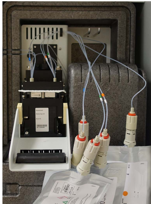
Bild 6-20 Saugfähiges Papier in der Aufnahme des MultiPort Ventils
