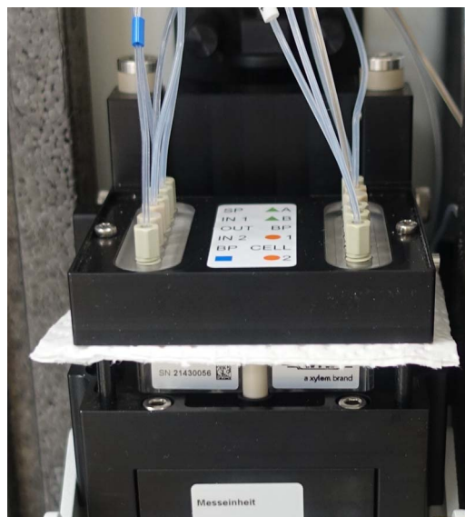
Bild 6-5 Entfernung von Flüssigkeitsresten mit saugfähigem, fusselfreiem Papier
