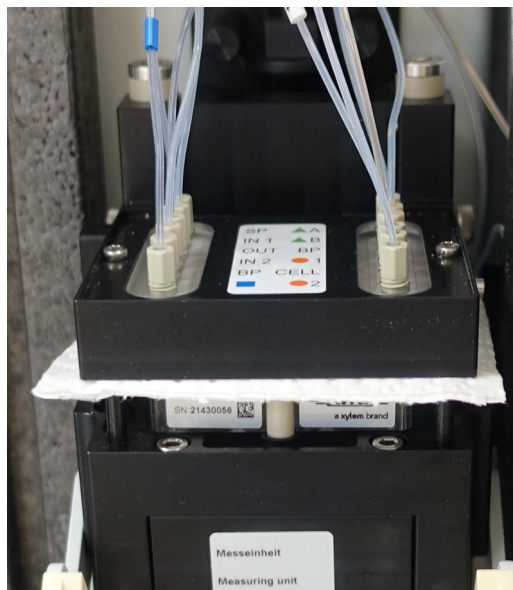
Bild 6-2 Entfernung von Flüssigkeitsresten mit saugfähigem, fusselfreiem Papier
