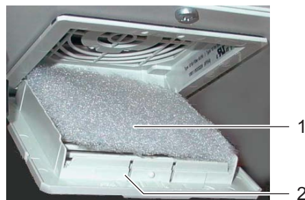
Bild 6-16 Untere Filtermatte wechseln
