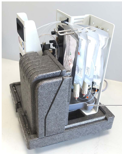
Bild 6-7 Position der Auffangwanne in der Messeinheit (unter den ChemBags)
